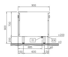
Electrical inlet (power) FΩ Equipotential screw
